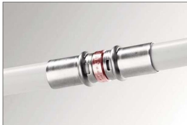
Le tube Fluxo® doit être introduit jusqu'en buté au fond du raccord. La lumière pratiquée dans la bague de sertissage permet de contrôler que le tube soit correctement introduit à fond.
