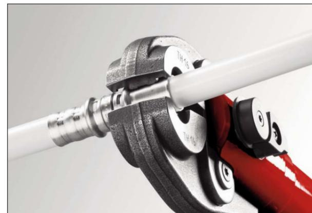
Placer le bourrelet de la bague de sertissage dans la partie femelle de la mâchoire prévue à cet effet.
