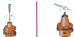
Le réglage des réducteurs de pression s'effectue toujours sans écoulement, c'est-à-dire robinets fermés en aval. On affiche donc une pression «statique».
