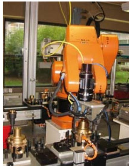
*Machine automatique pour l'assemblage des réducteurs de pression*
