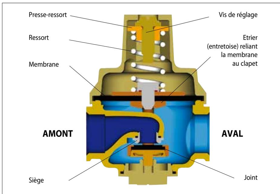
La membrane est soumise sur toute sa surface inférieure à la pression en aval. La force donnée par cette pression comprime le ressort dès qu'elle devient supérieure à la force du ressort et provoque la fermeture du clapet. Cette situation demeure tant qu'il n'y a pas de puisage en aval. La pression en aval est donc maintenue à la valeur souhaitée par le réglage.
