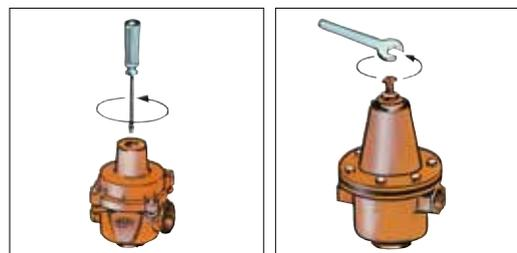
Pour des applications domestiques, la pression recommandée est sensiblement de 3 bar : c'est la pression sous laquelle les robinets sanitaires sont testés à la norme en débit et en acoustique. Dans le cas de longueur importante de tuyauterie entre le réducteur et le premier point de puisage ou pour alimenter des niveaux plus élevés ou en contrebas, le réglage doit être adapté. Se rappeler par ex. que 10 m plus haut on dispose d'un bar de moins.
