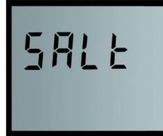
Appuyez sur **[SET]** et maintenez le bouton enfoncé jusqu'à ce que le symbole « **SALT** » à l'écran disparaisse. Remplissez l'appareil de telle sorte qu'aucune impureté ne puisse entrer dans le **bac à sel (14)**. **Le cas échéant, nettoyez le sel ainsi que le bac s'ils sont sales.**
