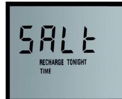
En pressant une fois la touche [SET] (entrée), l'heure de régénération est validée et l'affichage passe au mode de réglage du type de sel utilisé.
